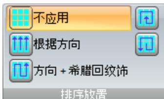
**排序放置：**右侧的另一组按钮可以改变板材上的放置需要的排序类型（参见：[嵌套配置 -> 排序逻辑](#)）。如果已经计算求解，则直接应用更改。
